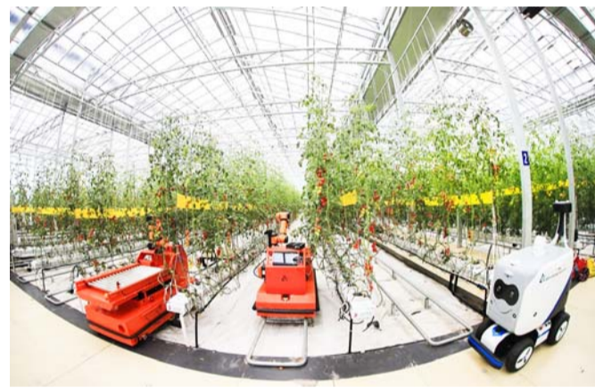
寿光智慧农业科技园里的多功能机器人，具备流水作业、自动导航、实物识别等功能。
