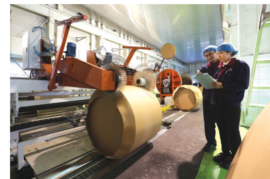
□ 记者 孟一 通讯员 刘浩 报道 太阳纸业食品纸车间员工检查卷筒自动包装机器人的运行情况。
