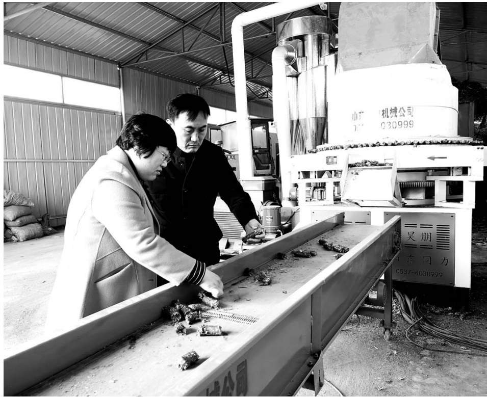
泗水县中册镇生物质能源取暖项目秸秆固化生产现场。
