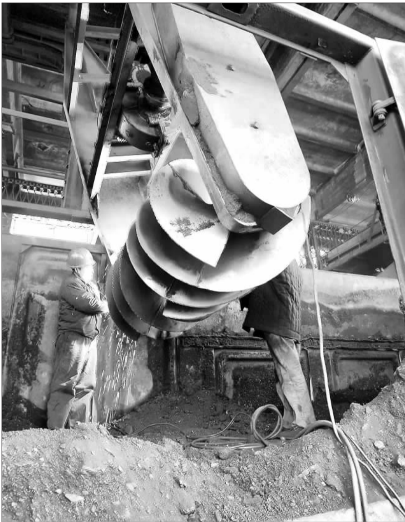
卸煤机结冰无法运行,几位工人用电锯磨掉冻在机器上的煤块。 本报记者 邱志强 摄
