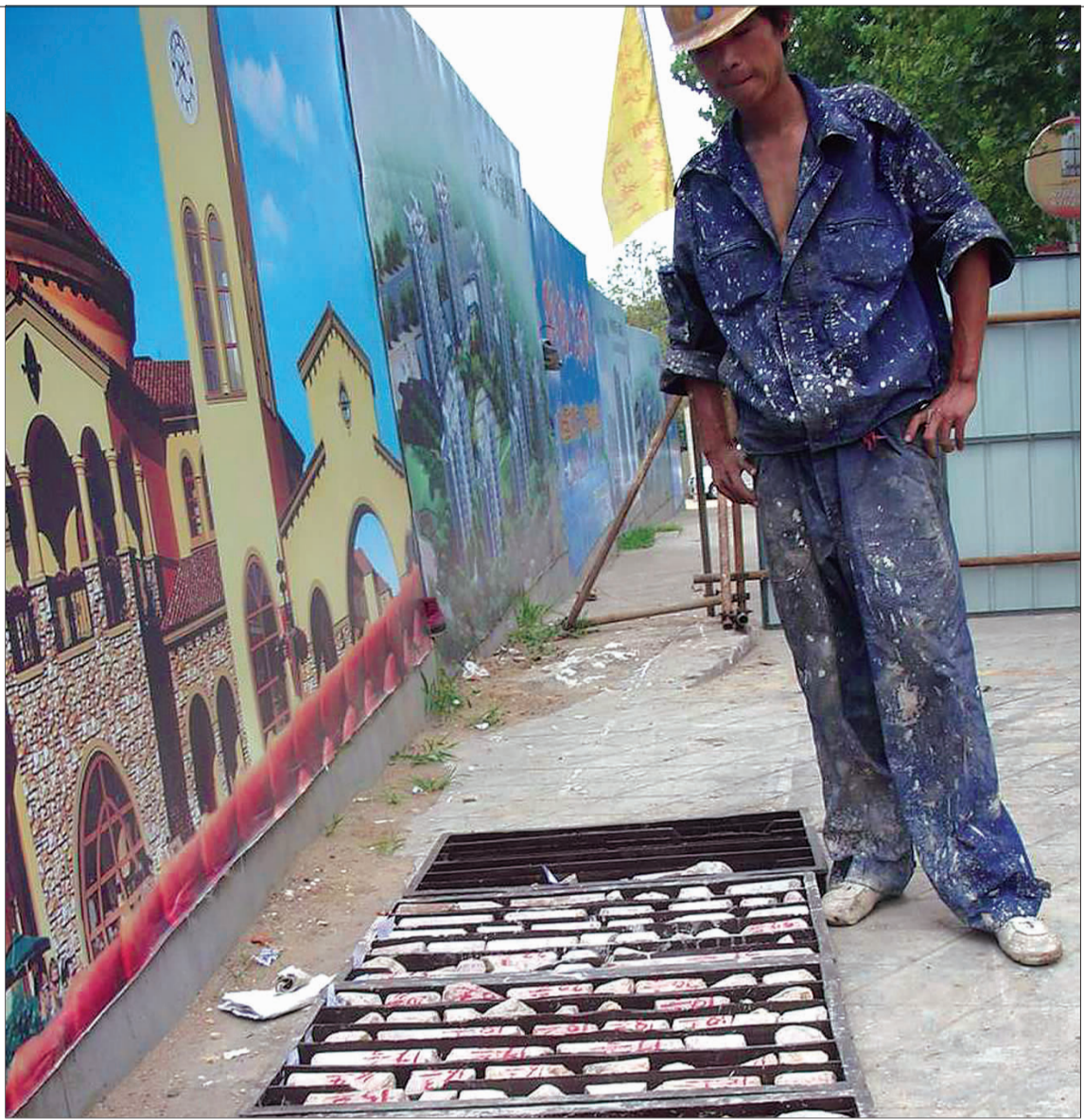
地铁一期地质勘察有望月底结束。工人高威钻孔打到了地下30米取出的岩石样品整齐地摆放在取样盒里。 宋珊珊 摄
