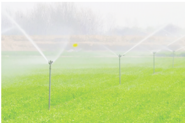
种粮大户杨承东地里的地理式伸缩喷灌设备正在浇地。
