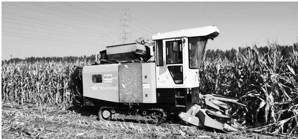
履带式青贮打捆一体机正马不停蹄地“吃”着玉米秸秆。
