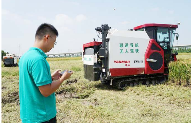
技术工程师通过手机操控无人收割机收割水稻。
