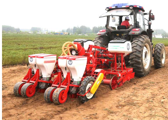
正在田间作业的气吸式花生起垄精播联合作业机。
