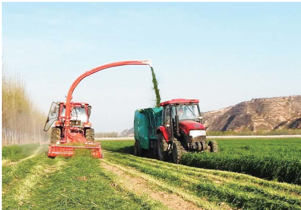
这是山东省农机院研制的多功能青贮收获机(配捡拾割台)在河南一家农场进行燕麦裹包青贮作业。
