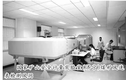
国家矿山安全计量实验室(济宁)煤矿风表检测风洞
