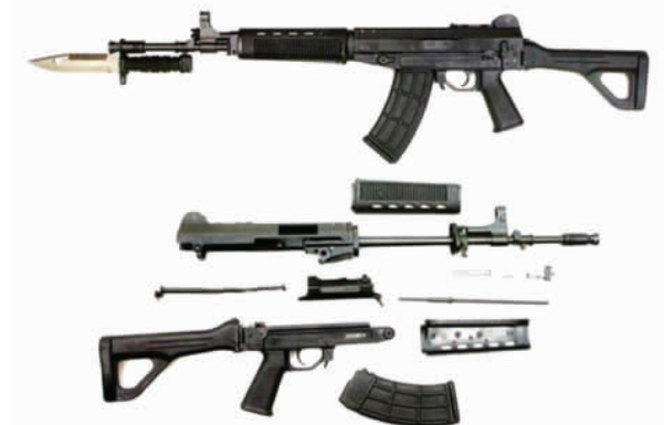
03式突击步枪分解图。 □ 资料图
