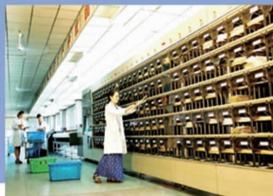
▼每小时能分拣3.6万封信函的自动分拣机
