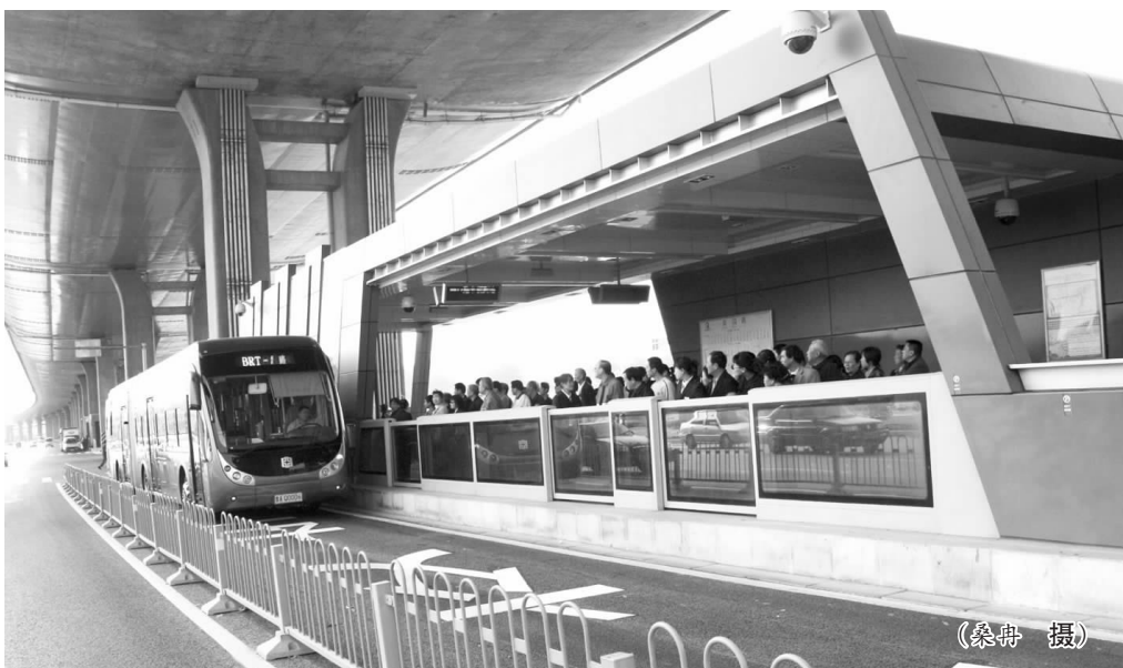
济南 BRT 大桥旁正在等车的乘客与驶来的 BRT 公交车，该车为中通客车制造的 LCK6180G，长 18 米，采用进口级盘设备，一级踏步方便乘坐，并有残疾人乘车设备，可承载 175 人。
