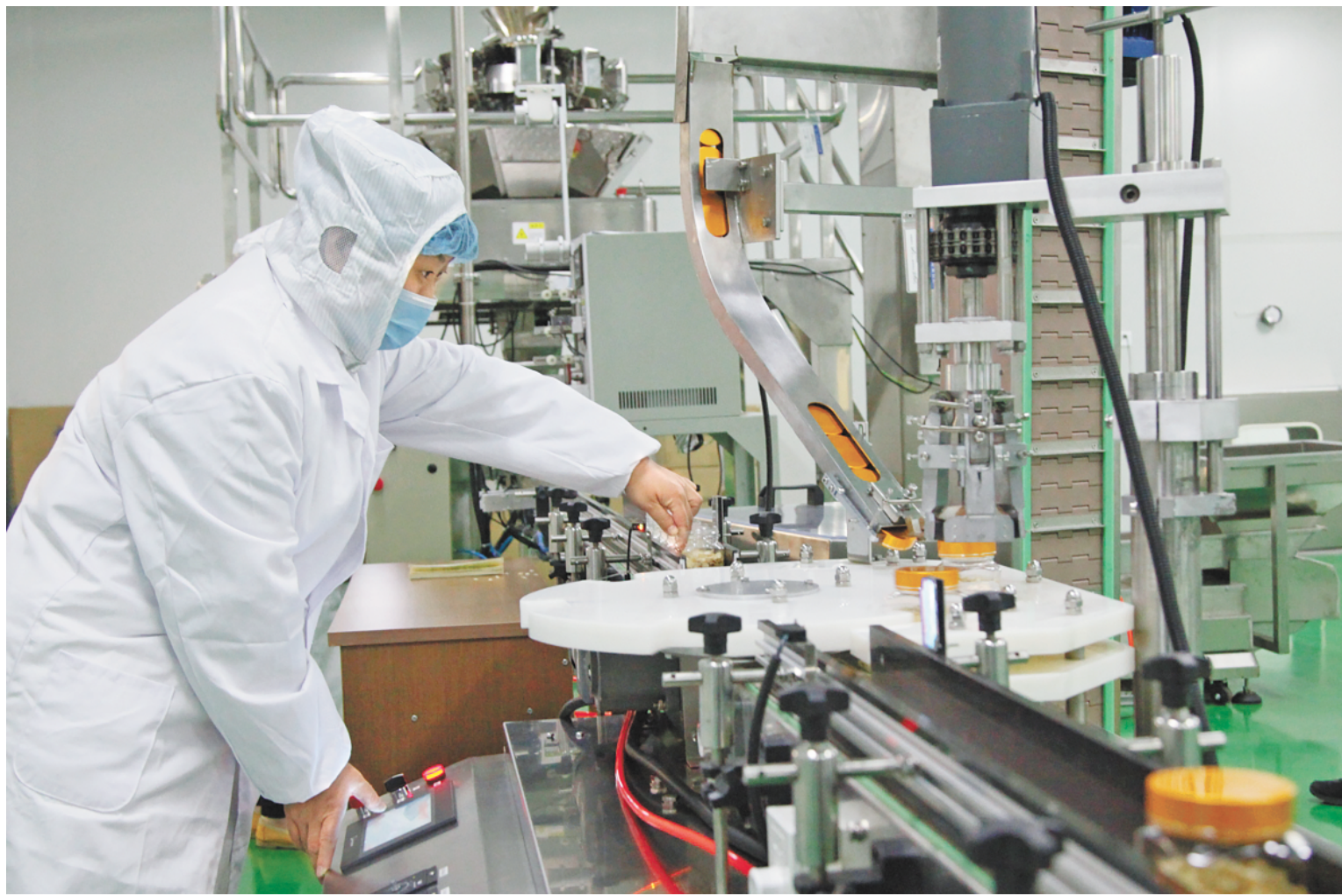
在威海金太阳药业公司的西洋参软枝切片生产车间,工人在流水线上对软枝切片灌装密封。
