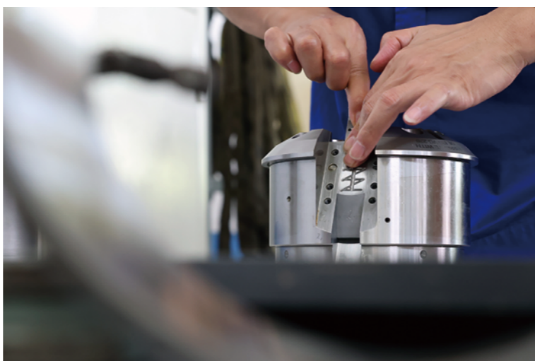
在王树军的精心研磨下，精密部件配合达标，配合间隙不超过0.5丝（1丝等于0.01毫米）。
