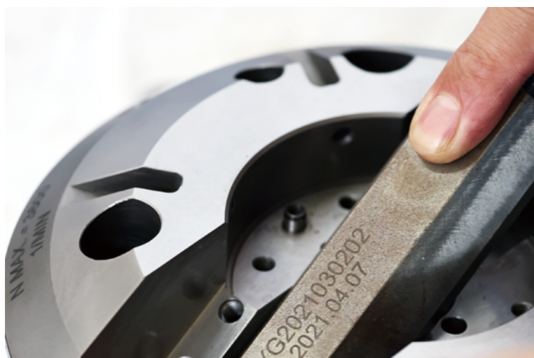
王树军自己设计、制作研磨工具，用以提高精密部件的维修精度。
