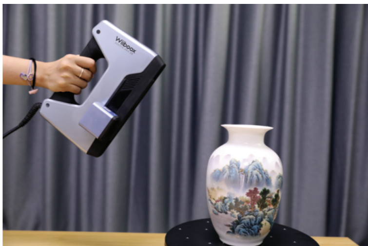
圆引动漫公司综合使用厅内，三维部技术人员使用三维扫描仪扫描花瓶，实现实物的虚拟化数字变身。
