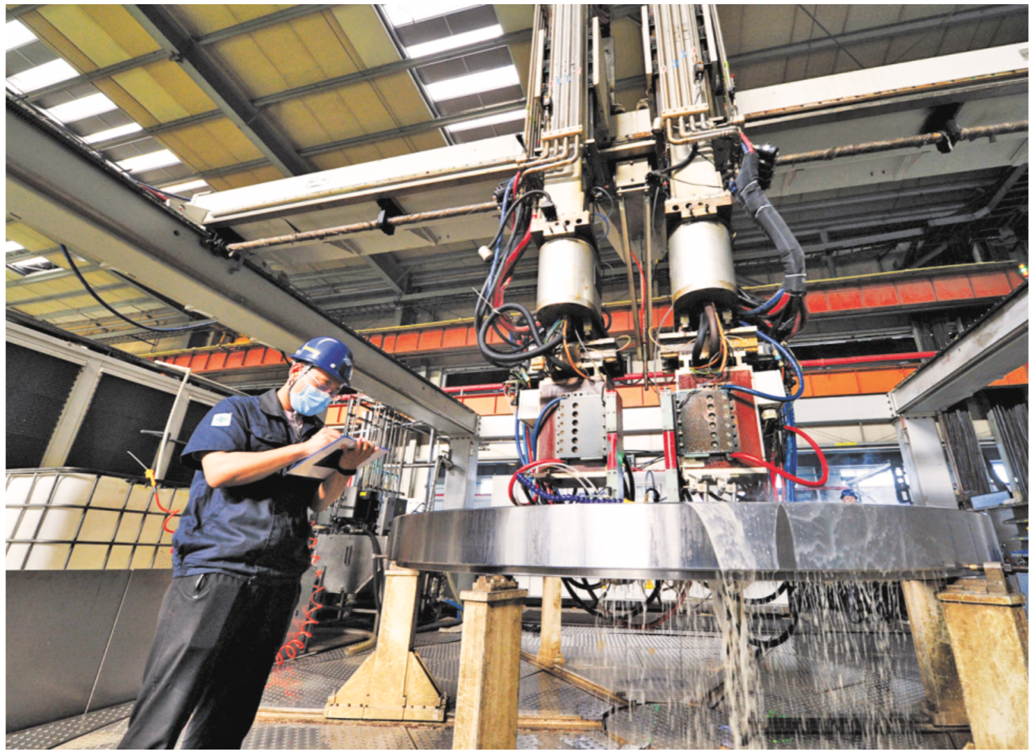
工人在烟台天成机械有限公司车间内进行制齿工件加工。
