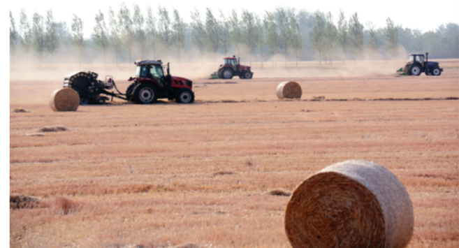
耩草机、打捆机等机械正在小麦收割后的麦田里收集秸秆。
