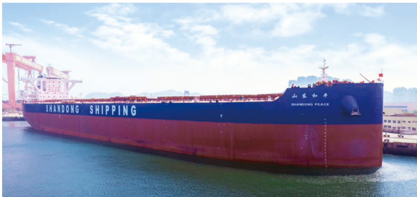
5月18日,“山东和平”轮命名交船仪式在青岛举行。“山东和平”轮是山东海洋集团所属山东海运与中国船舶集团青岛北海造船有限公司4艘21万吨散货船项目的收官船,该船延续了行业前端的设计理念,装配有预旋导管和消涡鳍组合节能装置,主辅机配备脱硝装置和脱硫洗涤系统,满足氮氧化物三阶段排放标准,在航速、油耗等综合性能方面达到世界一流水平,获得了英国劳氏船级社、中国船级社特别授予的“ECO绿色船舶”附加标志证书。
