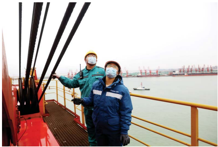
山东港口日照港岚南#15泊位, 40米高的装卸平台上, 商玉霞(右)和技术员一起查看卸船机钢丝绳的工作状态。
