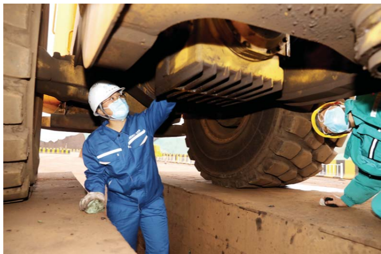
发现一辆装载机底盘油管渗漏, 商玉霞(左)与技术员商量如何维修。
