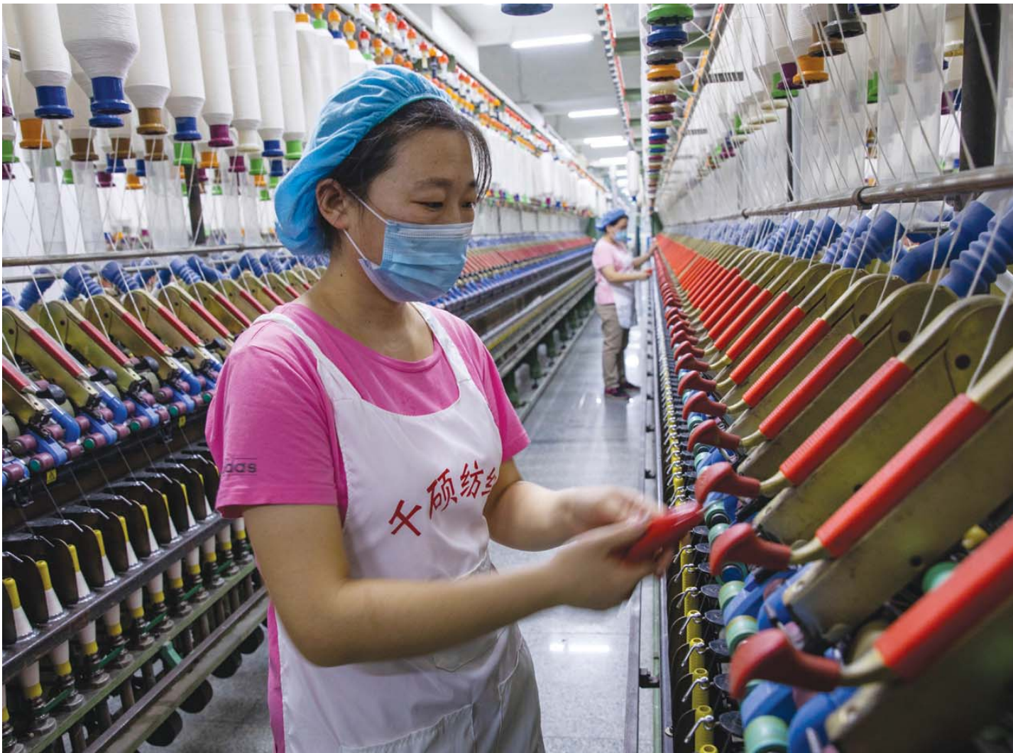
□记者 李明 通讯员 刘云杰 报道 12月16日，在东营市千硕纺织有限公司，工人们正在紧张作业，加工订单产品。该公司新上5万纱锭智能化高档精密梳纺项目，采用自动化在线检测、反馈处理系统，细纱自动落纱技术，自动插管筒机等国内外先进纺纱技术和设备，大大提高了生产效率。
