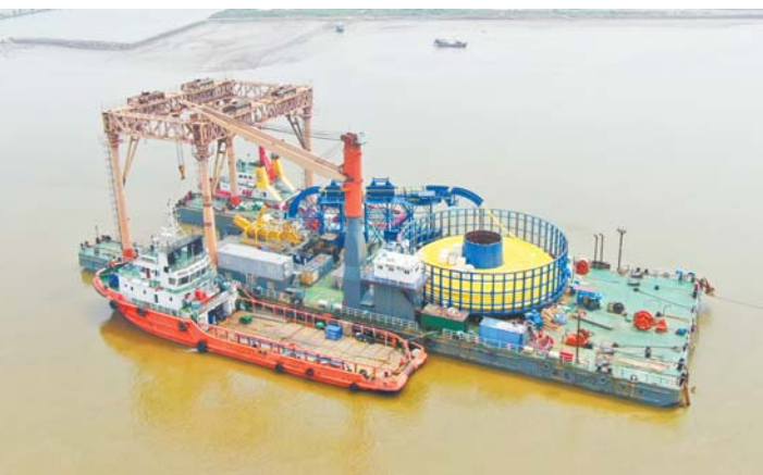
□记者 卢鹏 通讯员 高士东 张桂芹 报道 7月23日，无棣县东风港港口，由无棣海忠软管制造公司生产的6英寸、8英寸海洋复合软管装配起锚，运往渤中油田。据悉，这是国产海底软管首次铺向渤海湾油田。
