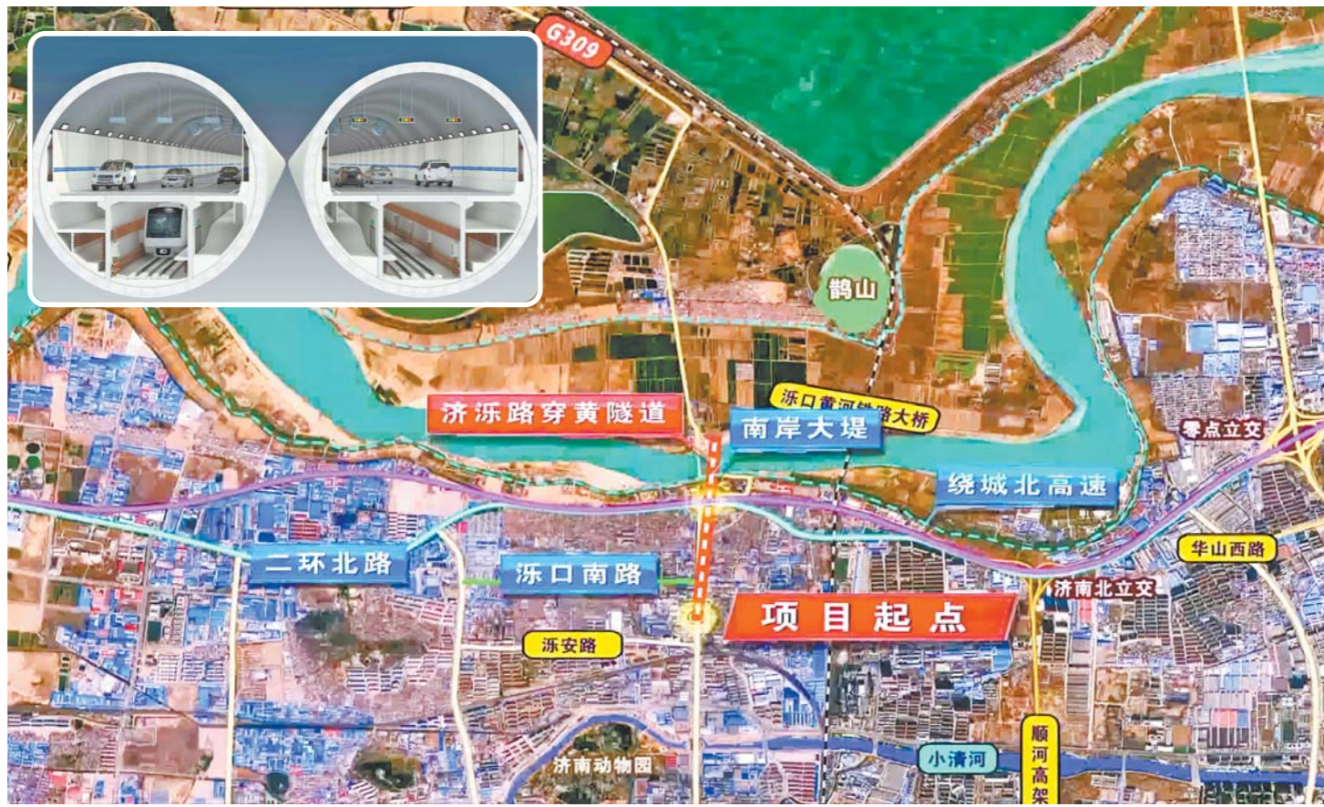
大图：济南黄河隧道效果示意图。隧道建成通车后，开车最快4分钟可穿越黄河。 小图：设计为双管双层公轨合建盾构隧道，上层为公路双向6车道，下层为轨道交通以及排烟通道、管廊和逃生通道。
