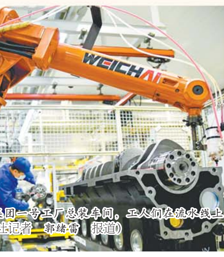
去年8月，在潍柴集团一厂总装车间，工人们在流水线上装配发动机。（□新华社记者 郭露露 报道）
