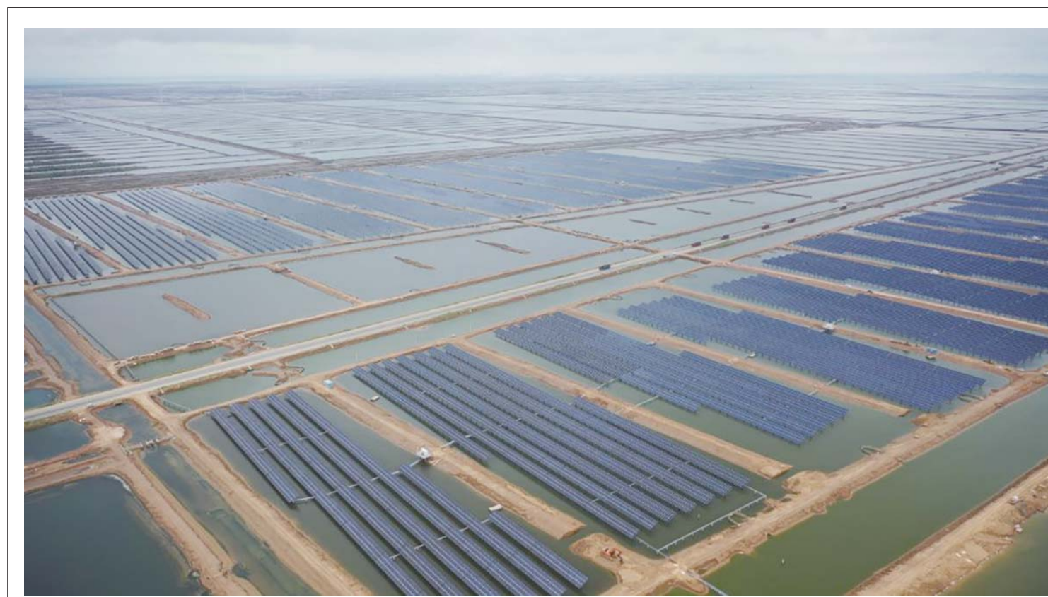
□记者 姜斌 通讯员 贾海宁 李雪 宋宏伟 报道 总投资15.24亿元、占地7800余亩的滨州市沾化区滨海镇通汇“渔光一体”现代产业园,采用渔光一体模式进行综合开发,将光伏电站与养殖业相结合,在虾池上建设光伏电站,形成“上可发电,下可养殖”的发电模式,将现代智慧农业、光伏产业进行科学、有机的结合,并适度叠加休闲观光农业,打造集新渔业、新能源、新农村为一体的“三新”现代产业园,把不毛之地变成寸寸寸土的宝地,实现了向盐碱地要效益。该产业园是目前全国最大的单体“渔光一体”项目。
