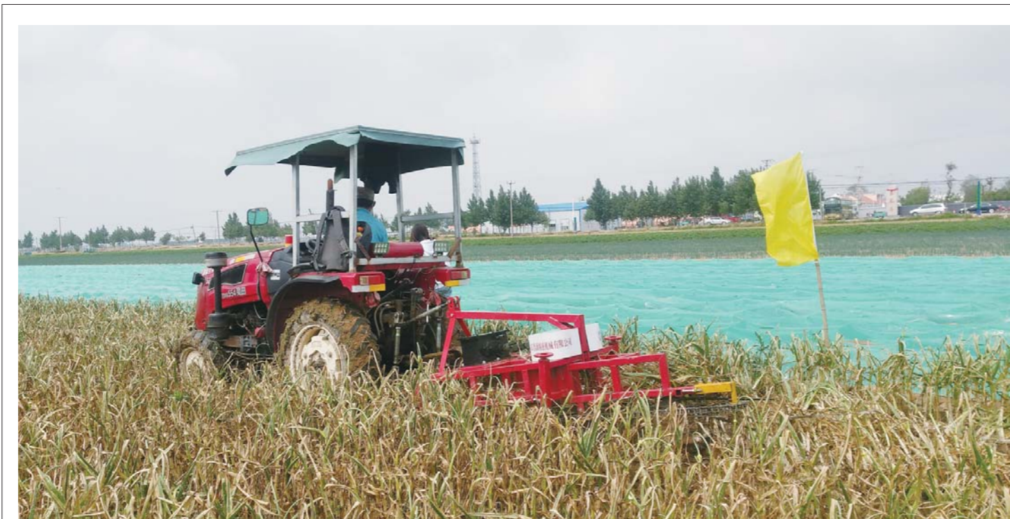
由山东省农业机械科学研究所主持的省重大科技创新工程——“低损高效大蒜收获关键技术与装备”项目和青岛农业大学主持的省农机装备研发创新计划——“大蒜生产机械化与农艺技术融合研究与验证”项目科技成果现场演示观摩会,近日在青岛市露地蔬菜新技术试验示范平度东寨子基地举行。图为观摩会上展示的低损高效大蒜收获机。
