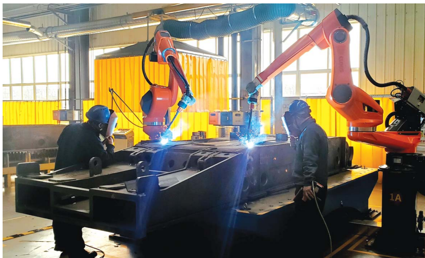
兖矿东华重工煤机装备制造分公司结构件车间的焊接机器人在工作。
