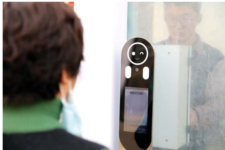
济南市章丘区刁镇，伟丽种苗公司技术人员正在调试智能化温室门口的人脸识别系统，系统用于控制人员进入，降低污染风险。
