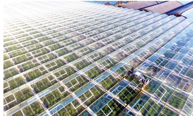
绿隆农业公司，技术人员操控玻璃清洗机高效清洗智能温室天窗玻璃，保证温室光照。
