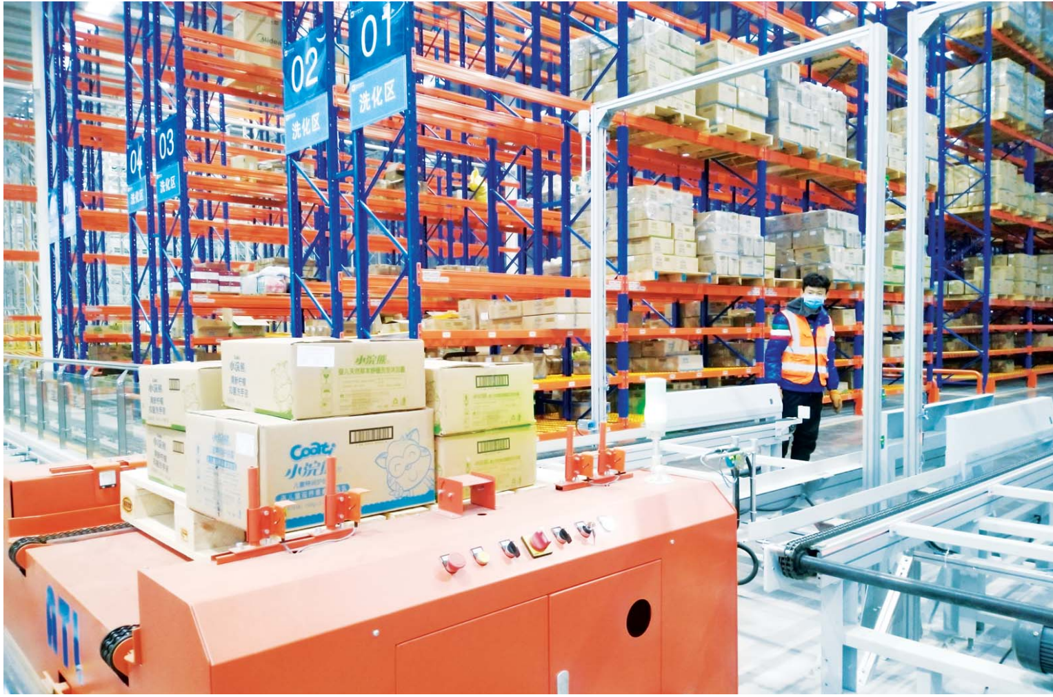
罗宾逊智慧云仓项目借助标准化托盘为货物形成“电子身份证”，分拣、取货、出库一分钟即可完成，实现了自动化智慧仓储。图为3月9日，一辆自动滑轨车将货物从仓储区运送至仓库门口。
