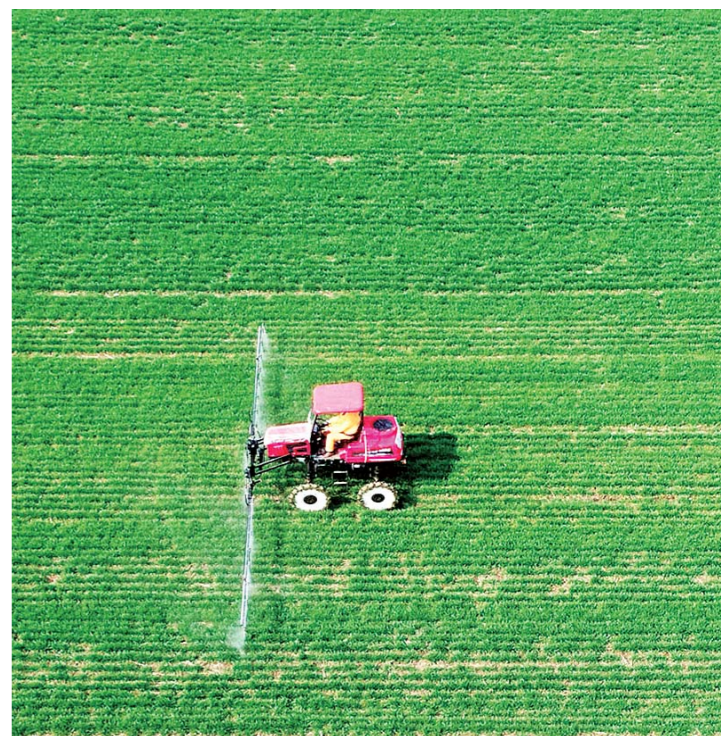
2月26日，郯城县郯城街道新村村，农民驾驶自走式喷杆喷雾机在麦田里作业。 □新华社发
