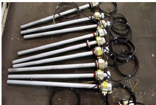
固定隧道管片的螺丝钉有近一米长，每个都带有探测头。
