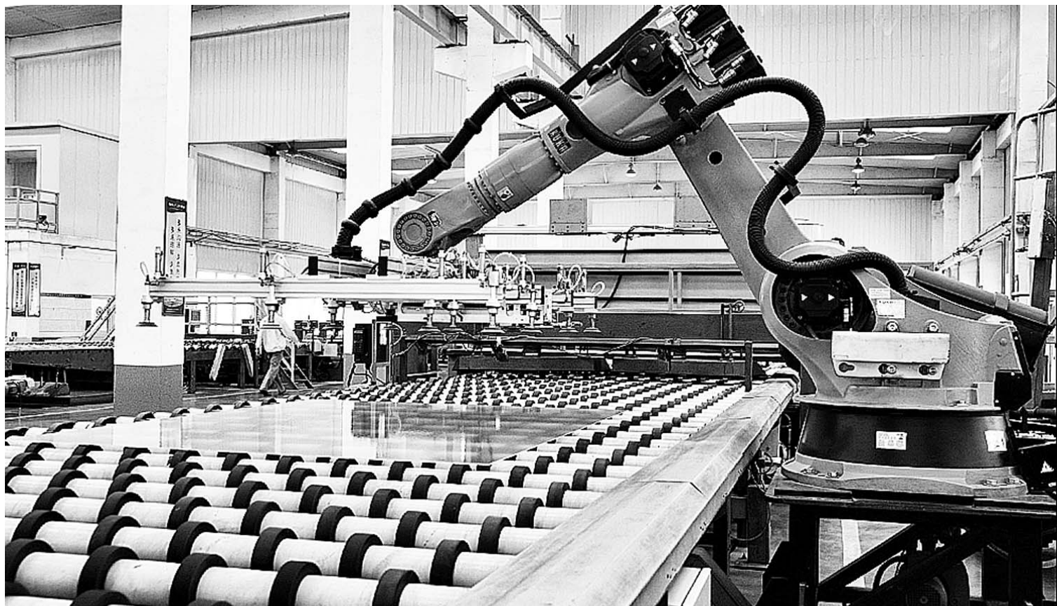
2019年,淄博市智能制造向纵深推进,培育22家智能工厂,135个智能车间,上云企业突破6000家,预计两化融合水平保持全省前列。图为金晶集团高档浮法超白玻璃生产线。
