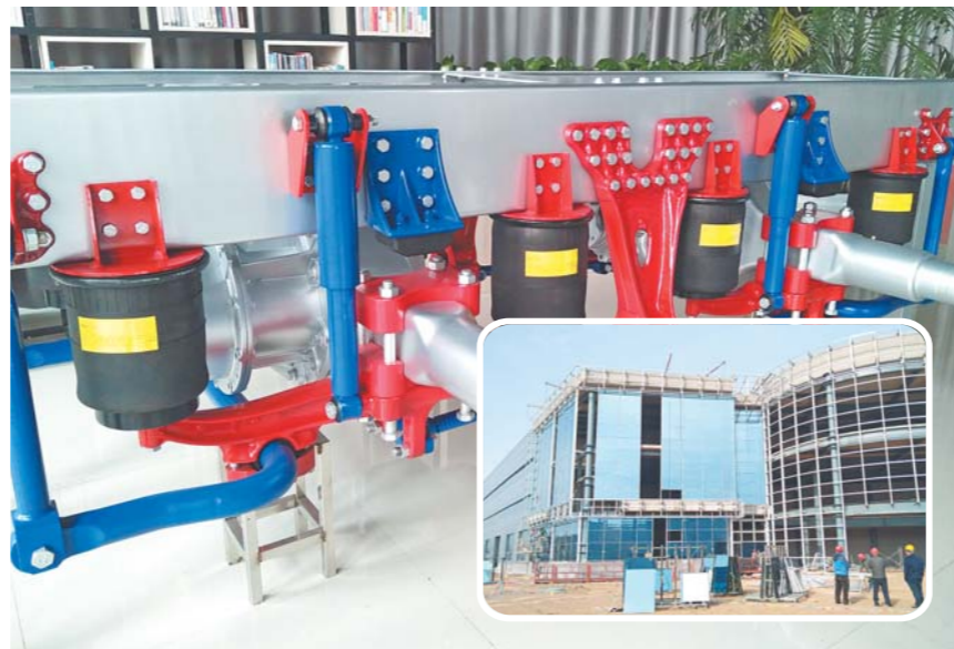
大图:使用在货车上的美晨空气悬架。小图:美晨工业园二期厂区正在进行最后装修。(□记者 杜文景 报道)
