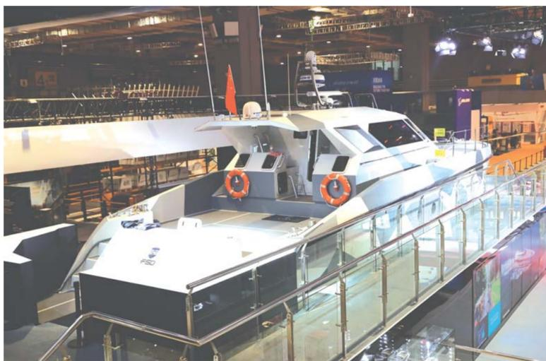
意大利法拉帝带来了最新型号195型公务船。该艇全长20米，重约37吨，采用碳纤维和钛金属等新型材料，最高速度超过55节，最大续航
