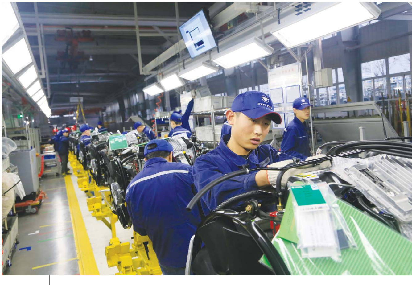
福田汽车山东超级卡车工厂总装车间内，工人正在进行发动机分装作业。(资料片)
