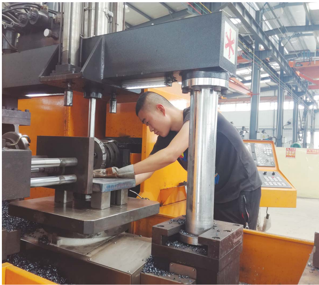
在山东展宇钢材有限公司，工人正在将钢材放置到数控铣床上。
