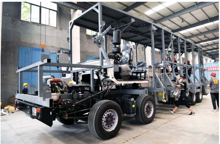
大型货车底盘经过改造成为彩车的骨架部分，创作者所有的奇妙梦想都将在这上面实现。
