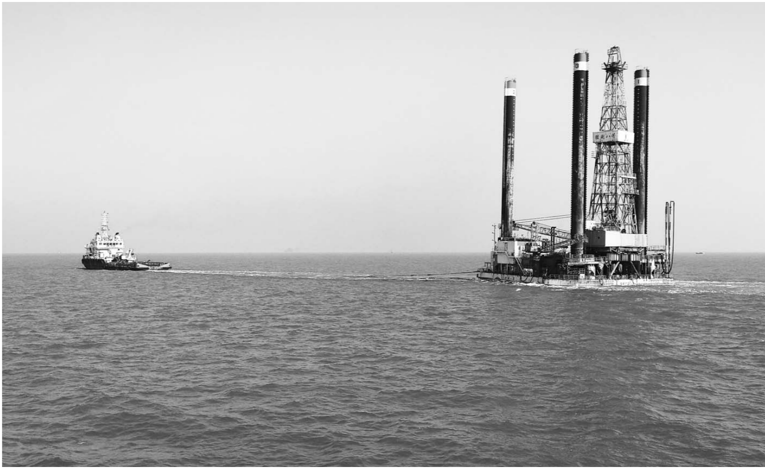
8月21日，海洋石油船舶中心胜利281、胜利262、胜利241三艘大马力拖轮顺利完成胜利八号、胜利五号平台长距离拖航移就位作业。此次拖航是将两座平台从CB20CB-15井拖至烟台打捞局，总航程120海里。由于距离较远，海况复杂，中心拖航小组制订了详细的拖航计划，通过对风向、流向、海况等要素进行精准预判，成功将两座平台拖至烟台打捞局。
