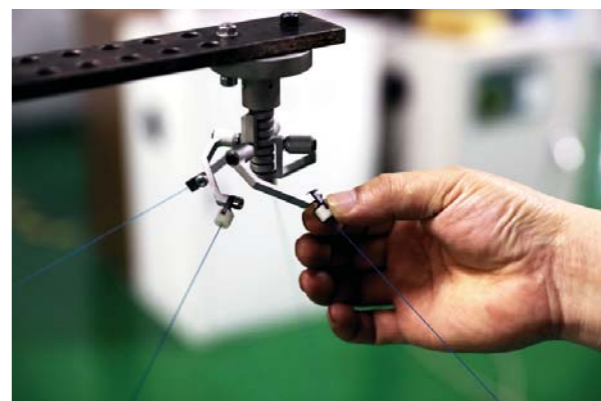
诺伯特厂区内的工业机器人检验检测中心，技术人员给待检测的机器人装配特殊丝线，以使用校准系统精确采集机器人运动过程中的位置信息。
