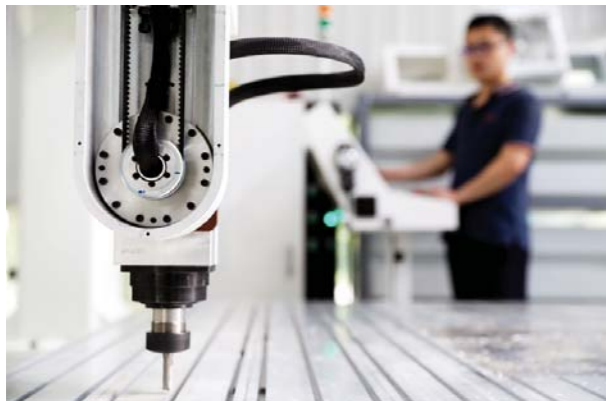
装配车间内，工人正在调试诺伯特研发生产的非金属加工中心，该设备广泛应用于箱包、汽车内饰等非金属产品加工。
