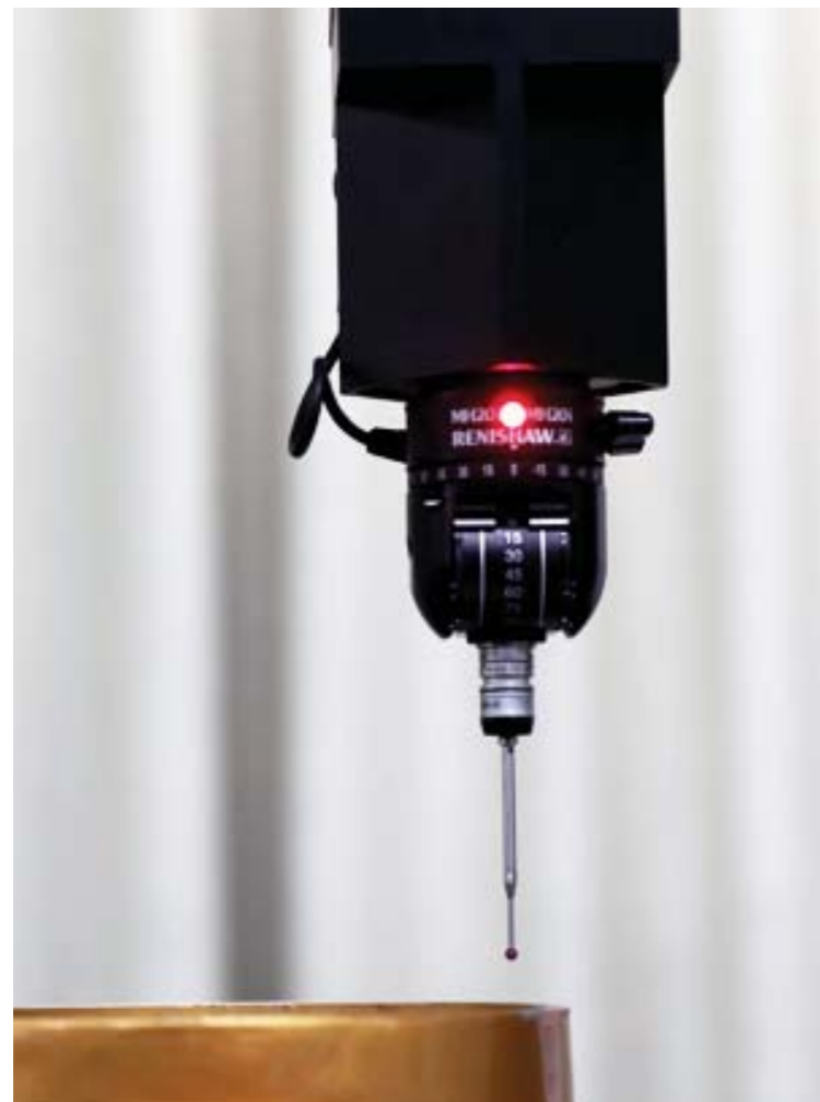
工业机器人检验检测中心的三坐标测量仪，正在对机器人部件的尺寸精度、几何精度、轮廓精度等数据进行测量。
