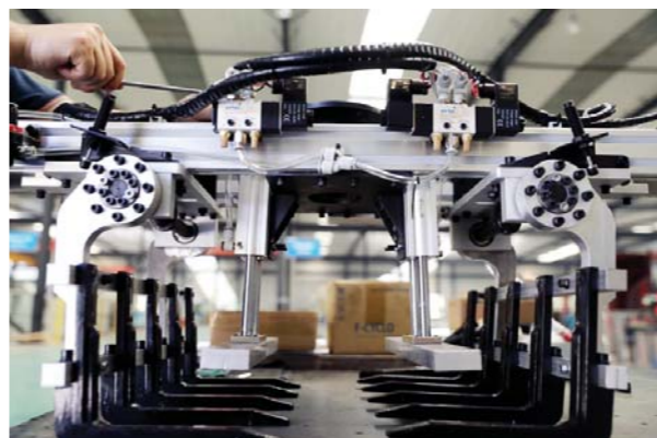
工人正在调试一台机器人抓具，这种通用性抓具可以高效完成袋式、箱式等产品的抓取、搬运和码垛等工作。
