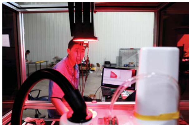
技术员按照客户要求，正在组装一套包含视觉相机和机械臂的智能化生产单元。
