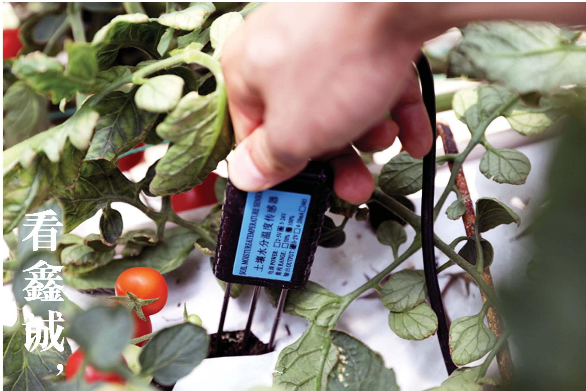
鑫诚现代农业科技示范园，智能温室里，工作人员正在放置土壤水分温度传感器，传感器可向环境控制计算机传送土壤温度、湿度数据。
