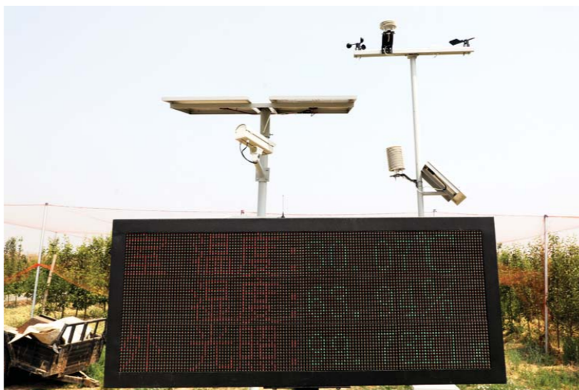
大田里装备的智能气象站，可实时监测上传气象数据，是重要的物联网信息设备。
