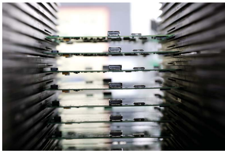
装在特制容器内，准备进入组装工序的主板，它是制造智能设备的关键部件，相当于设备的“大脑”。
