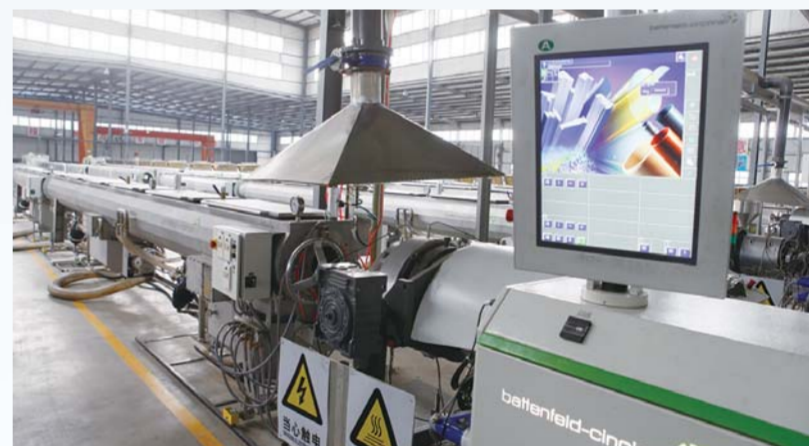
△华信塑胶升级后的管材自动生产线
