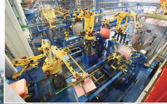
△阳谷祥光铝业阳极铜自动化生产车间
