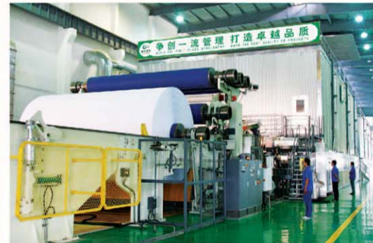
△央企中冶纸业银河有限公司20万吨高速造纸机
