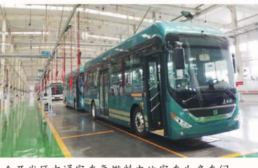
△开发区中通客车氢燃料电池客车生产车间
