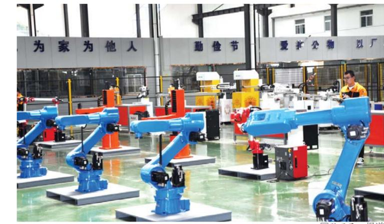
诺伯特智能装备(山东)有限公司的多关节机器人综合测试区，工作人员正在现场调试。
