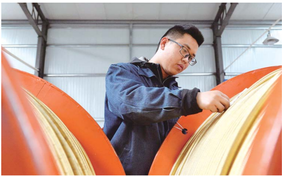
爱科公司技术人员正在检测编制胶管外观质量。
