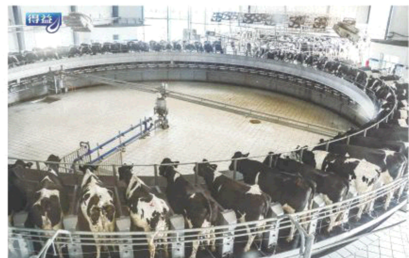
得益乳业国际先进的瑞典利拉伐80位重型转盘挤奶设备
