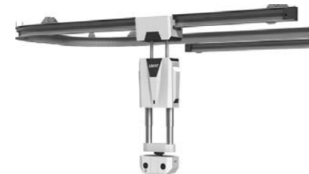
▲山东鲁能智能技术有限公司自主研发的“室内轨道巡检机器人”
