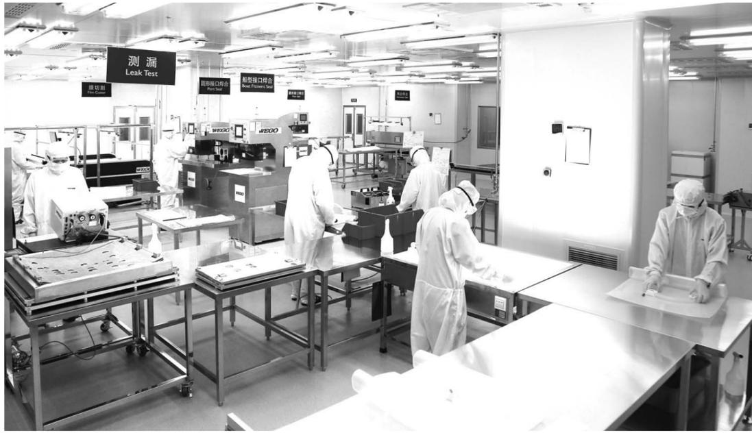
全新投产的生物工艺一次性耗材生产线。
