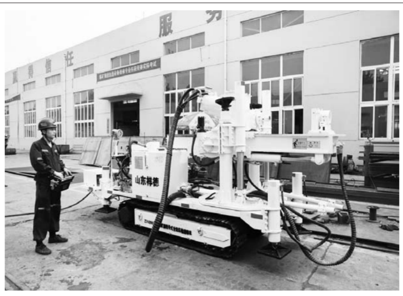
日前,山东能源临矿集团古城煤矿与山东祥德机电有限公司合作研发的液压钻车投入使用。这种高效智能遥控液压钻车适用于冲击危险性高、卸压施工过程中易诱发冲击、造成重大危害的地点。
